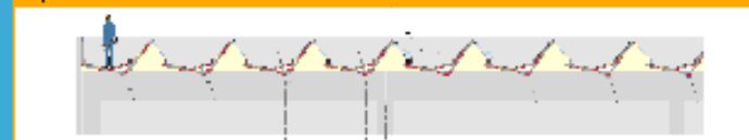
Tegole di copertura soluzione Minished con luci fino a 25 mt.
