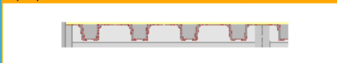
Tegole per solai da 80-100 cm, con luci fino a 20 m.
