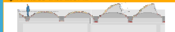
Tegole di copertura soluzione Minished con luci fino a 25 mt.
